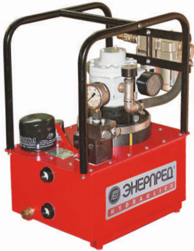
Модель: НПР-1,6А10-МЗлкФМ с фильтром влагоотделителем, маслораспылителем (ФМ)
