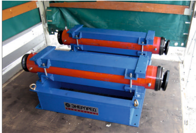
ЦС200Г1250Ш в составе установки для прокола грунта
