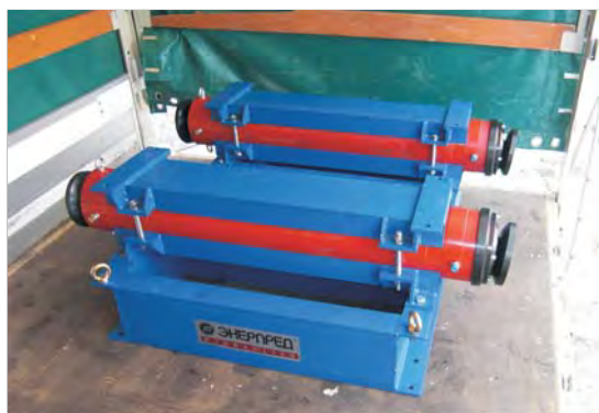
ЦС200Г1250Ш в составе установки для прокола грунта
