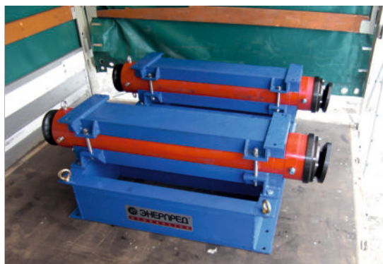
ЦС200Г1250Ш в составе установки для прокола грунта
