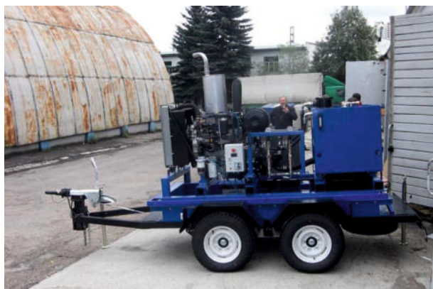
Гидростанция для ГНС-362ДР, с дополнительной опцией на колесно-прицепной базе
