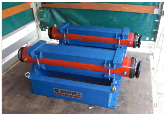
ЦС200Г1250Ш в составе установки для прокола грунта
