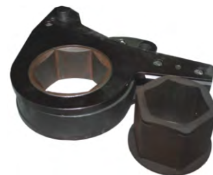
Модель: Кассета (серия СБ) со сменной головкой (серия ГС)
