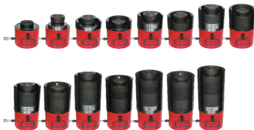
Последовательность работы системы ступенчатого подъема
