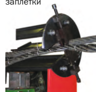
Заведение петли каната в поворотный зажим
