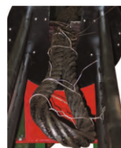
Заведение петли каната в поворотный зажим
